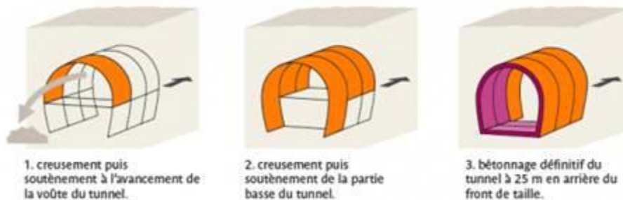
Figure 8 : Schéma de la méthode traditionnelle du tunnel voûté
